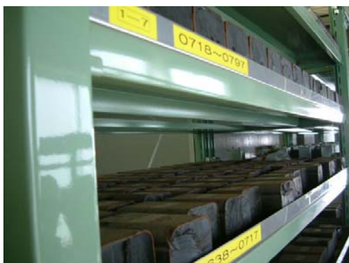
切断された廃安定器の保管例（１）
