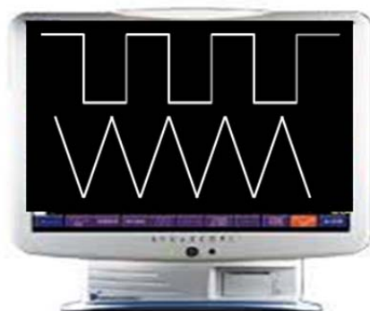
上段:矩形波の例 下段:ノコギリ波の例
