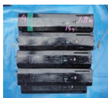
コンデンサーを内蔵する安定器の例
