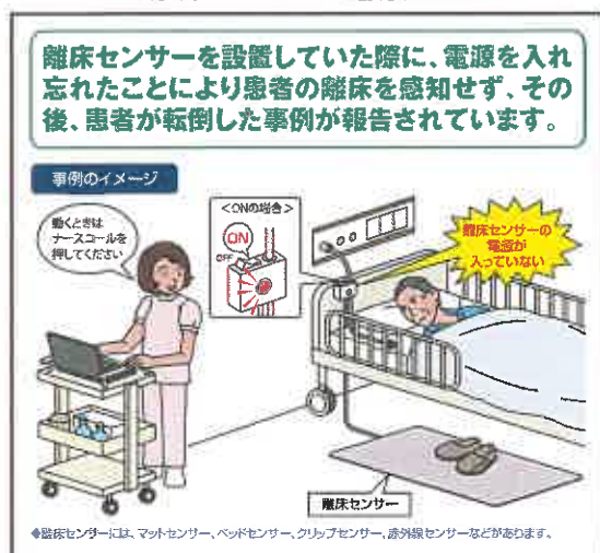
No.197 離床センサーの電源入れ忘れ
